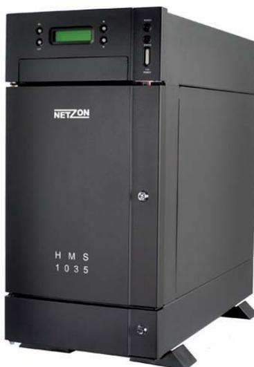
Der HIT Archivspeicher 1035 kann über entnehmbare 35-Slot Magazine be- und entladen werden. Die optischen Archive besitzen zusätzlich einen Mailslot für den Import / Export einzelner Medien (Austausch während des Betriebs – Hot Swap - möglich). Zum Lesen und Schreiben der optischen Medien werden hochwertige Industrielaufwerke eingesetzt, die sowohl Blu-ray Discs (BDs) als auch DVDs und CDs verarbeiten können.
